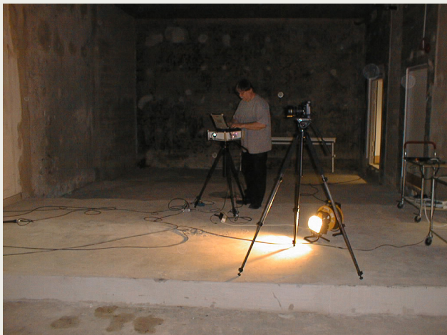
Figur 2. De två stativen med kameran respektive projektorn. På projektorn står datorn som styr allt. Projektorn projicerar från sidan så att operatören inte skymmer bilden. Fotodokumentation sker rakt framifrån.
